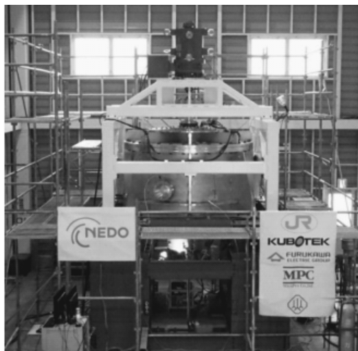
Рис. 8. Сверхпроводниковый КНЭ емкостью 100кВт·ч
