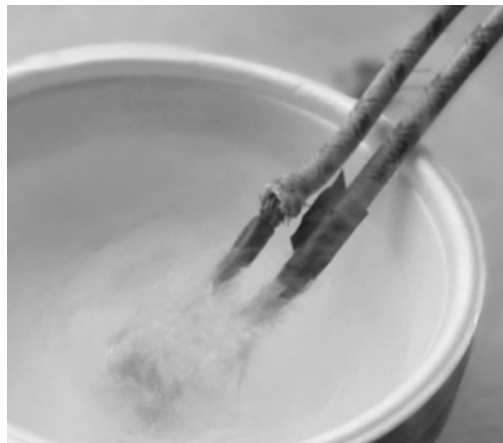
Рис. 4. Диод Semikron SKR47FT/021 в процессе эксперимента
