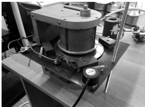
Рис. 3. Макетная модель униполярного двигателя
