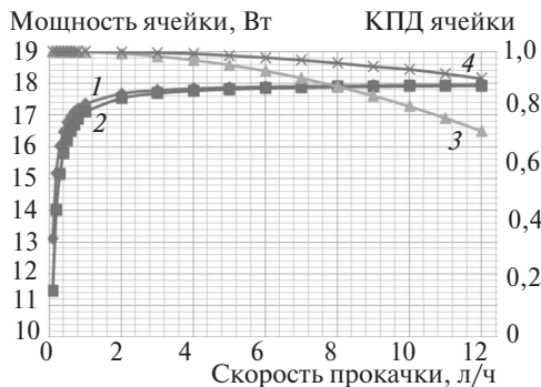
Рис. 8. Кривые зависимости мощности ячеек и их КПД от скорости течения электролита через ячейку: 1 – мощность ячейки 1; 2 – то же ячейки 2; 3 – КПД ячейки 1; 4 – то же ячейки 2
