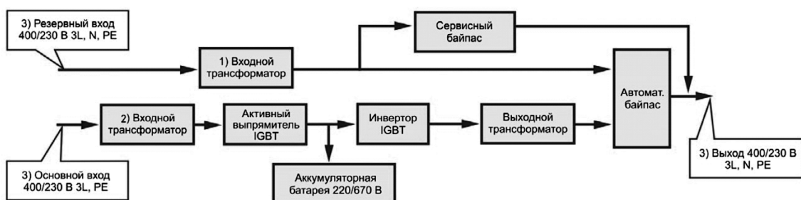
Рис. 9. Структурная схема СБП «Дубна»
