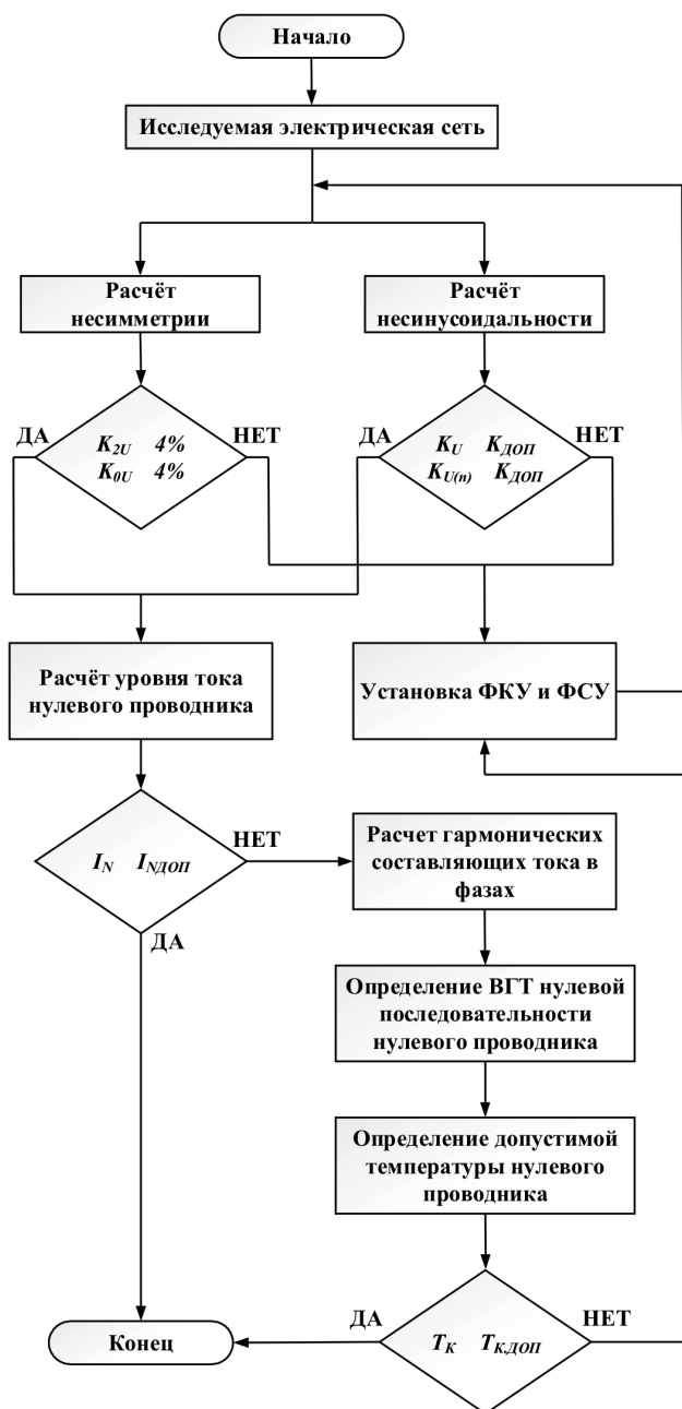
Рис. 6. Блок-схема алгоритма расчета гармонической составляющей тока нулевого проводника электрической сети с нелинейной нагрузкой для определения нагрева КЛ
