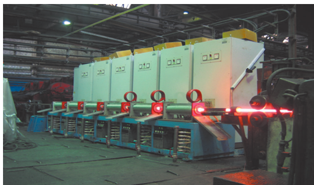
Индукционный нагреватель из шести модулей с производительностью 3 т/ч
