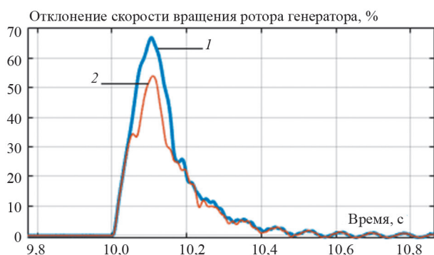
Рис. 9. Временные зависимости отклонения скорости ротора АСГ при КЗ на линии и ее отключении защитой: 1 – без изменения частоты на обмотке ротора; 2 – автоматическое регулирование частоты на обмотке ротора
