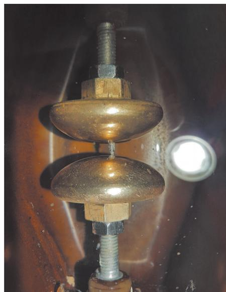
**Рис. 1.** Внешний вид электродов с образовавшимся каналом из продуктов распада вязкой ПМС-жидкости (ПМС–12500) после пробоя
