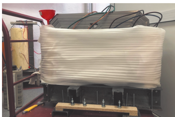
Рис. 4. Трехфазный экспериментальный образец ВТСП-трансформатора
