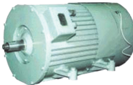
Рис. 1. Асинхронный тяговый двигатель переменного тока ТАД-3 для троллейбуса
