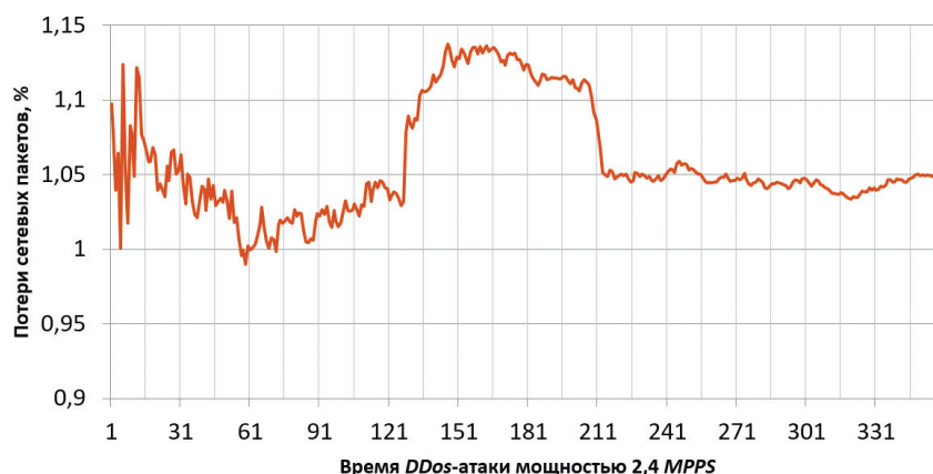
Рис. 6. Потери сетевого пакета при веерной атаке в 2,4 MPPS, %
