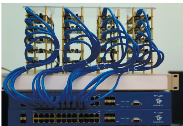
Рис. 4. Эмулятор DDoS -атак на базе Cubieboard2
