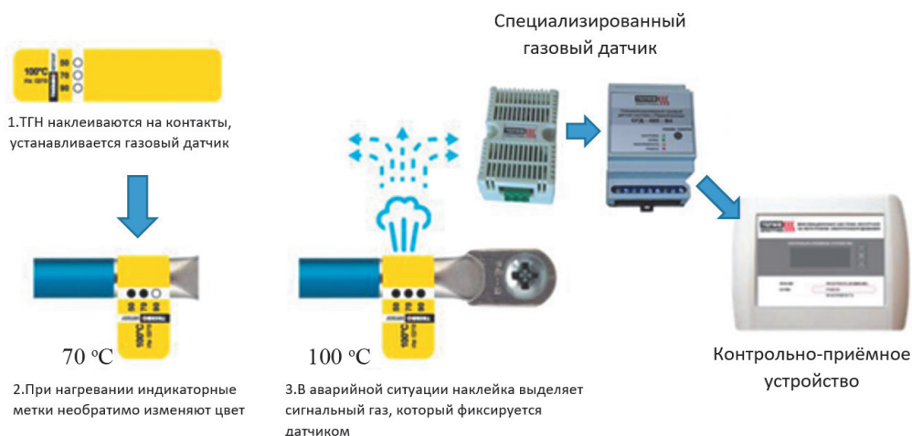
Рис. 4. Схема работы газовыделяющих компонентов САОП [21]
