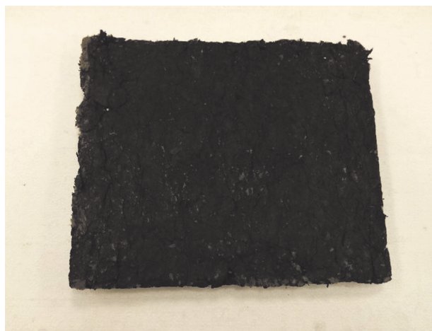
Рис. 2. Образец радиопоглощающего материала ТПМВ-1С
