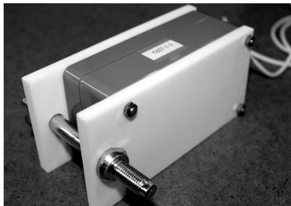
Рис. 3. Опытный образец оптического датчика тока ОД-1-1
