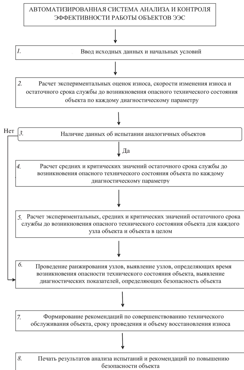
Рис. 3. Укрупненная блок-схема алгоритма контроля безопасности объекта по данным дискретного мониторинга
