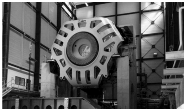
Рис. 5. Ветротурбина мощностью 3,6 МВт с возбуждением на основе сверхпроводящей керамики (проект EcoSwing)
